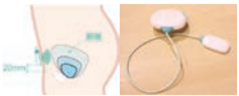
「DFree」本体。超音波センサ(右)を下腹部に装着し、膀胱の状態を取得、分析する
