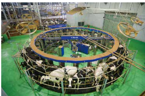
新型のロボット式パーラー。ほぼ自動で搾乳が完了する。
